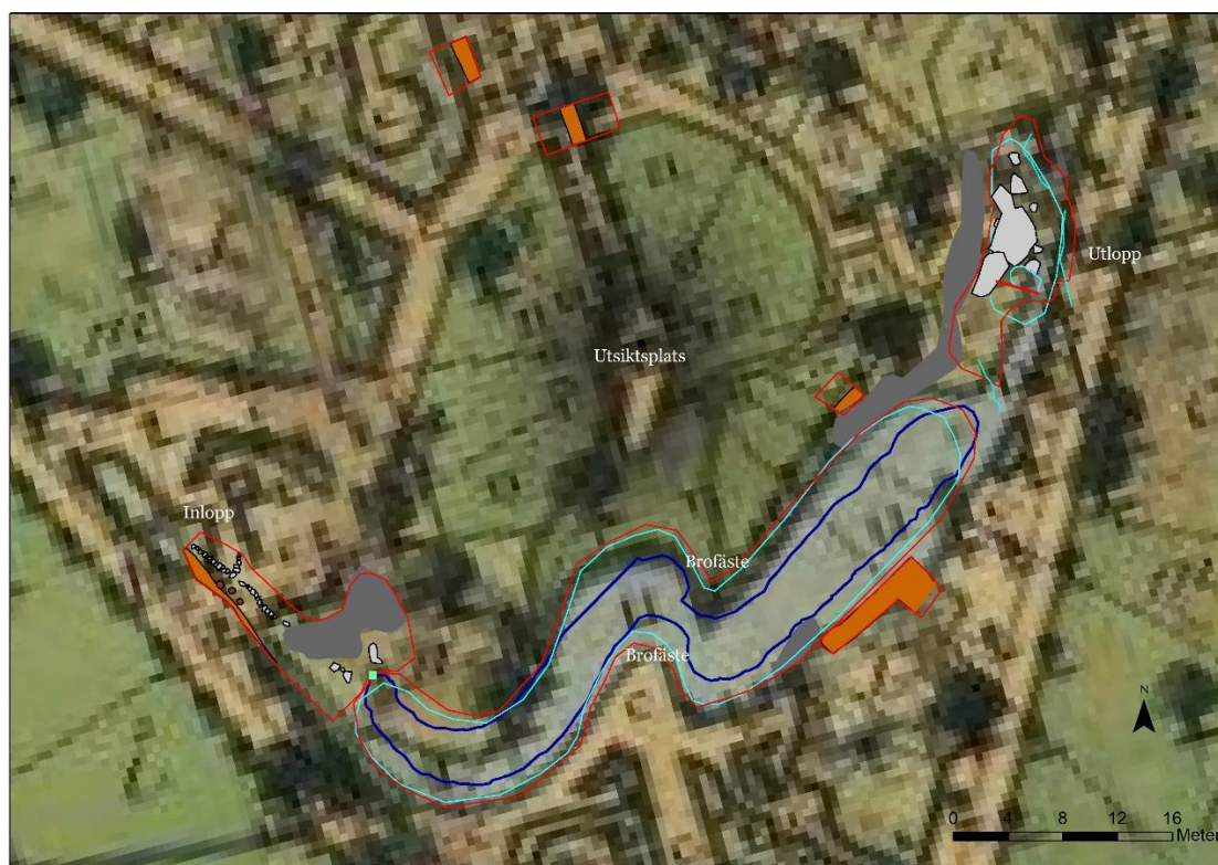
Figur 11. På planen är berg i dagen markerade med mörkgrått, sten med ljusgrått, nedgrävningskanter med ljusblått och gångvägar med ljusbrunt. Den mörkt blå linjen visar nederkanten på den kallmurade stödmuren. I bakgrunden ett utsnitt av Kökeritz karta från 1777.
